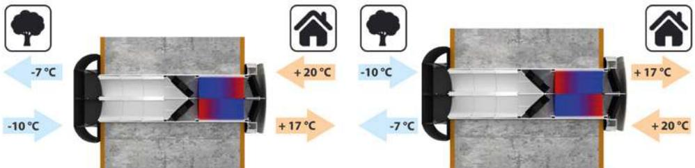
Der VENTO Expert Duo A30-1 Pro/W/W V.2 lüftet druckneutral und sorgt dafür, dass die verbrauchte Luft abtransportiert wird, wobei die Wärme erhalten bleibt. Alle 70 Sekunden wechseln die zwei eingebauten Lüfter die Strömungsrichtung.
