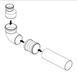
Bevor mit der Montage begonnen wird, müssen die Bauteile zusammengefügt werden. Stecken Sie die Bauteile gemäß der Darstellung fest zusammen, um eine dichte Verbindung zu erhalten.
